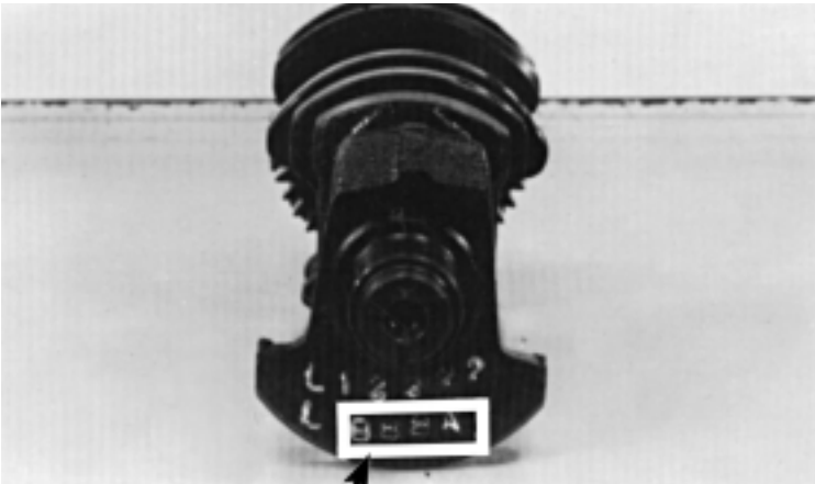
CÓDIGO DOS COLOS DAS BIELAS (DIÂMETRO EXTERNO)
