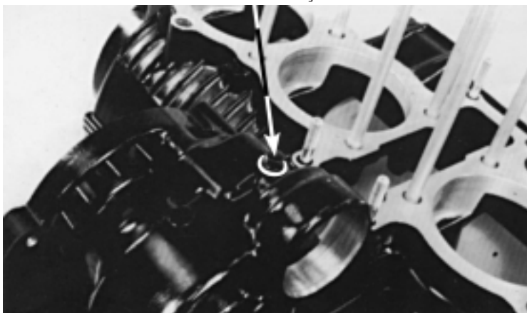
PARAFUSO DE FIXAÇÃO
