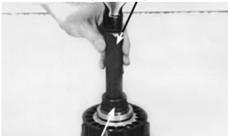
INSTALADOR DO ROLAMENTO, 24 x 47 mm (07746-0010300) GUIA DO ROLAMENTO, 20 mm (07746-0040500)
